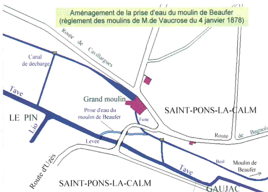
Figure 22: Alimentation en cascade des moulins Jean et Beaufer (source Association Saint-Pons-la-Calm Patrimoine)
