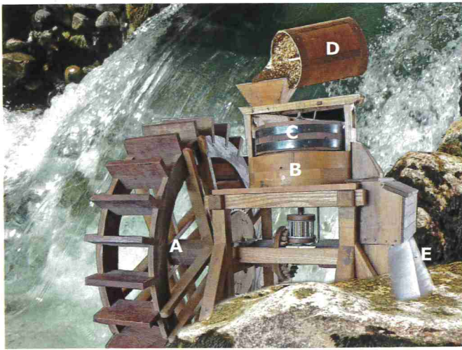
Figure 15: Principe d'un moulin à roue verticale
