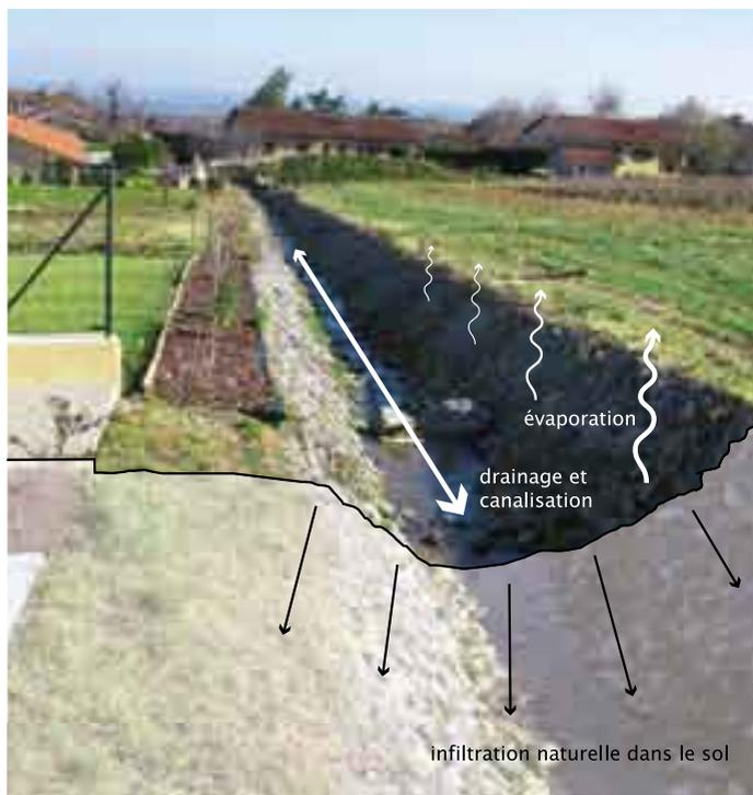
Schéma de principe sur une noue
