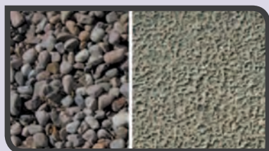
► Gravillons et béton lavés
