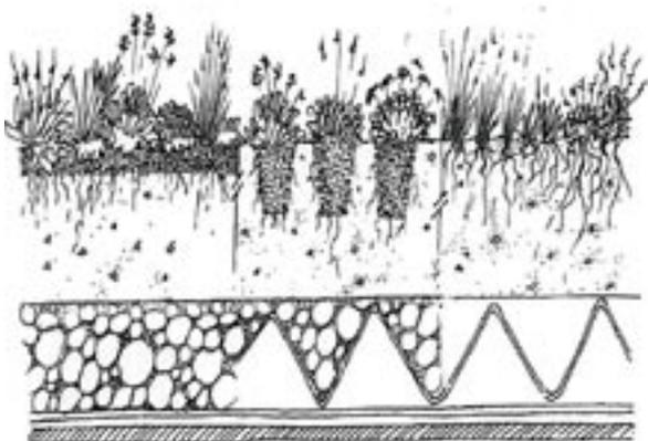
*Coupe type d'un toit végétalisé où se superposent la strate végétale, une membrane filtrante, la couche de drainage (agglomérés, ou modules de plastique remplis ou non d'agglomérés), une membrane anti-racine et enfin une membrane d'étanchéité*
