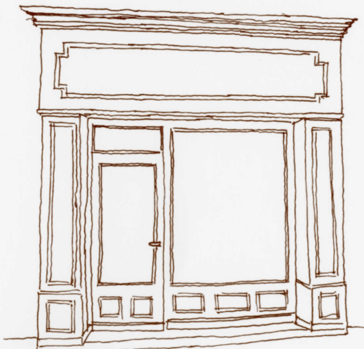
Le coffrage de bois dans le goût XIX ème habille élégamment une ouverture trop longue et basse
