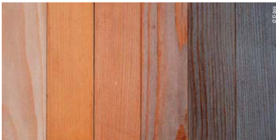
Influence du temps sur le type et l'intensité de l'altération due aux intempéries et sur la coloration du bois d'épicéa : d'une surface neuve, à gauche, à une autre fortement exposée à l'extérieur pendant 180 jours avec une orientation au sud et une inclinaison de 45°, à droite (Ei-bois).
