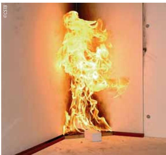
Mise en application du nouveau système d'essai européen de réaction au feu, SBI : Single Burning Item (EN 13823), réalisée dans les laboratoires du CSTB à Champs-sur-Marne.
