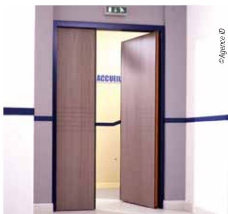
Bloc-porte 2 vantaux inégaux coupe-feu 1 heure, selon la norme EN 1634-1 - rapport d'essai CTICM n°06 1 3316 Vantaux à âme composite, deux parements à fibres de bois durs (bois exotique rouge), joints intumescents. Finition : prépeints, stratifiés, placage bois naturel, décors incurvés gravés.
