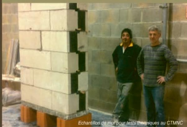
*Echantillon de mur pour tests thermiques au CTMNC*
