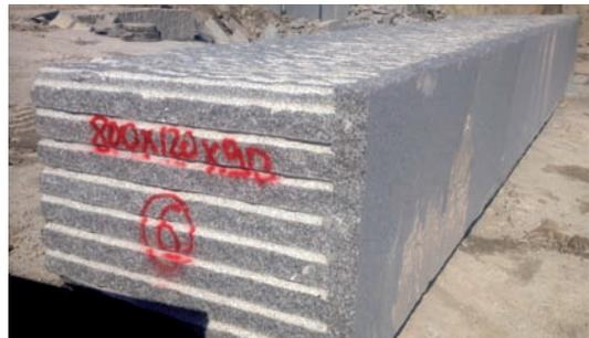
Une fois sciés dans la masse, les blocs de granit Silverstar de la carrière Plo ont été remontés et mis à dimension au monofil diamanté Chauvet. Les 800 m<sup>3</sup> de granit ont été livrés en trois mois. Le transport a été assuré par les entreprises du Sidobre Chrisange, Galinier et Marty représentant une centaine de voyages soit une moyenne quotidienne d'une rotation chacun.
