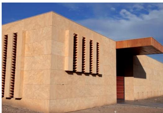
*Quelques détails des façades du chai réalisé par Pascal Carrère. La conception architecturale associée aux qualités d'inertie thermique de la pierre, permettent de conserver une température entre 9° et 23°, alors que, dehors, celle-ci peut descendre en dessous de 0 et monter au-dessus de 40°.*
