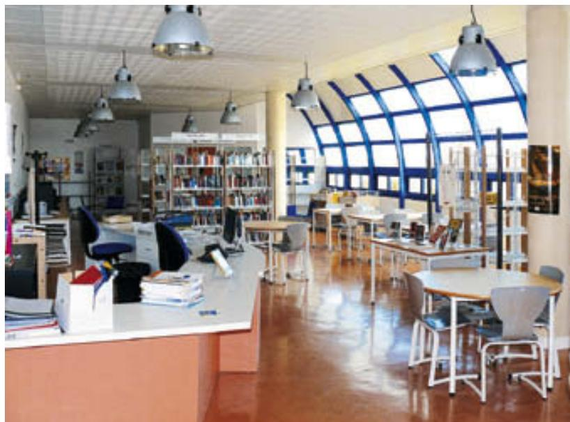
*Le CDI profite d'un éclairage généreux côté nord. La lumière directe est filtrée par des panneaux opalescents dans la partie supérieure des vitrages clairs.*
