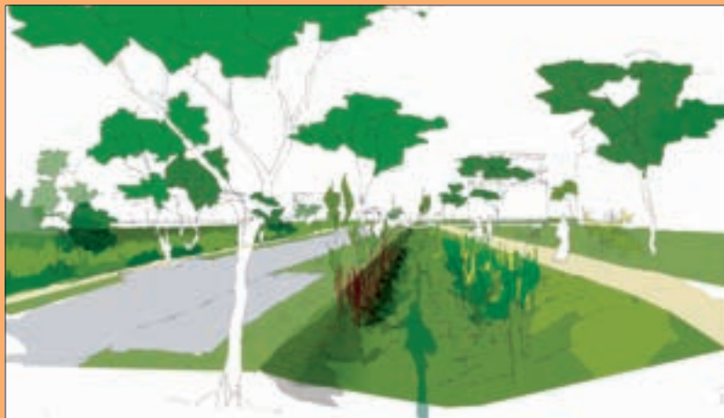
Un réseau de fossés et de noues draine les eaux de pluie et participe de l'aménagement paysager.
