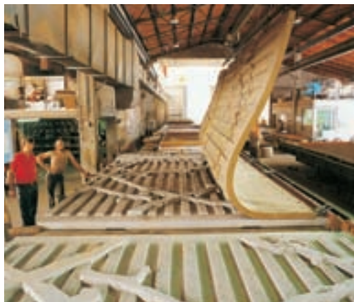
Réalisation de reliefs complexes obtenus à l'aide d'une matrice en élastomère.
