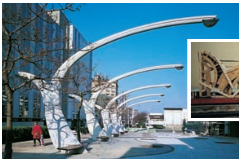
Flore Bringand, candélabres, Issy-Les-Moulineaux. Forme complexe présentant un porte- à-faux qui nécessite l'utilisation de béton précontraint par post-tension.
