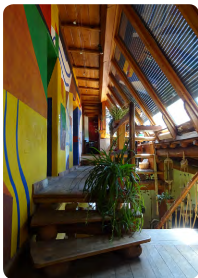
Intérieur. Le mur (à gauche) capte le rayonnement solaire l'hiver pour permettre la diffusion de la chaleur dans les chambres.
