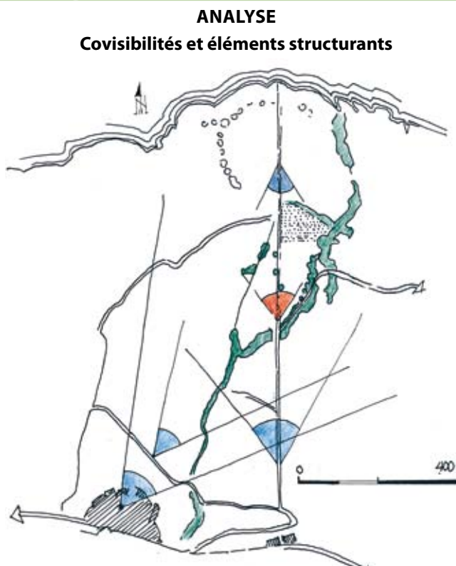
Le terrain, situé entre la ripisylve et la vigne, est invisible depuis le coteau du village. Entre les deux bras de ripisylve, il reste peu visible depuis les berges du lac et la voie rectiligne d'accès. Il semble, de ce fait, approprié pour accueillir l'aménagement demandé.
