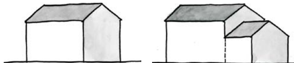
Corps principal et annexe (bâtiment secondaire)
